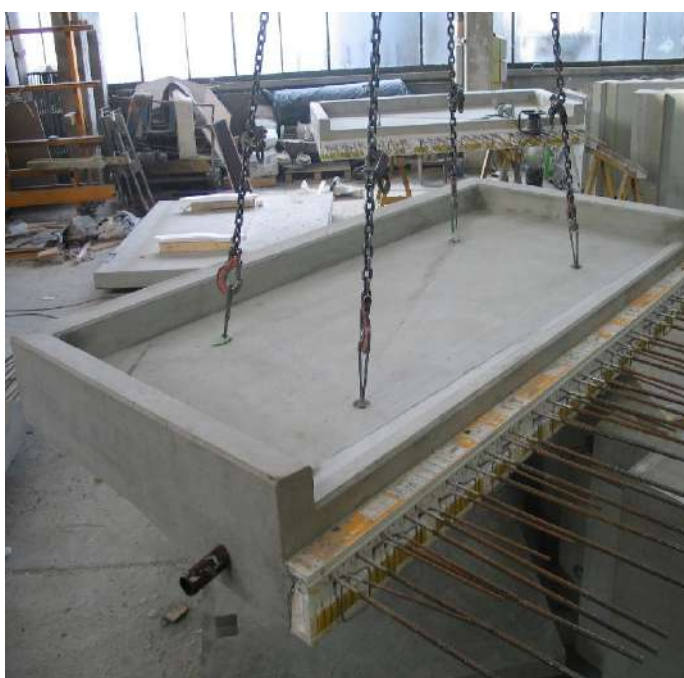
Bilde. Balkong med vannavledning
