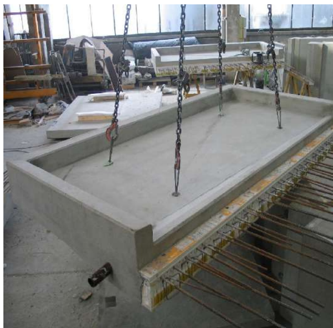
Bild. Balkong med vattenavledning
